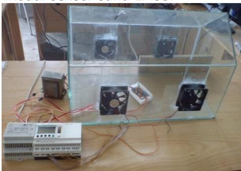
**Gambar 11.** Zelio SR3B261BD dan modul sensor suhu LM35
